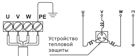
Рис. 4 Схема подключения для насосов 2,2 – 3,7 кВт. Прямой пуск. Электродвигатель со встроенным термодатчиком.
